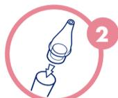
2 Присоединить сменную насадку к центральной части корпуса аспиратора (см. схему изделия).
